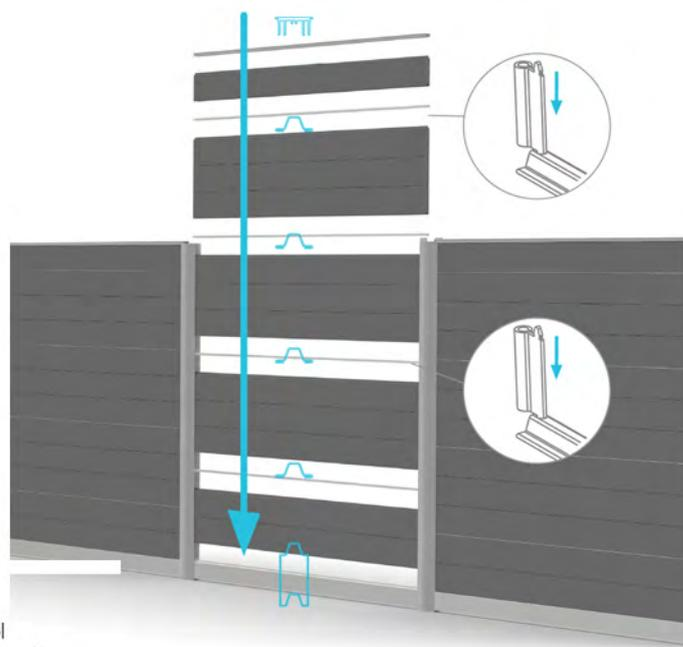
Le profilé inférieur se pose sur un sol stable, qui ne risque pas de s'affaisser, de façon que le profilé est complètement supporté (p.e. sable-ciment).
